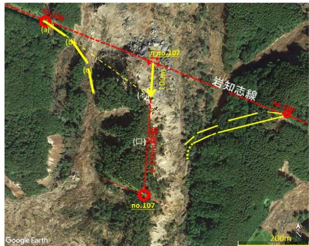
図-1 岩盤すべりによる送電設備の被災状況 (Google Earth 画像に加筆)
