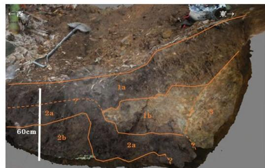
1a, 1b: colluvial wedge, 2a, 2b: 有機質砂層, 3: 砂礫層
