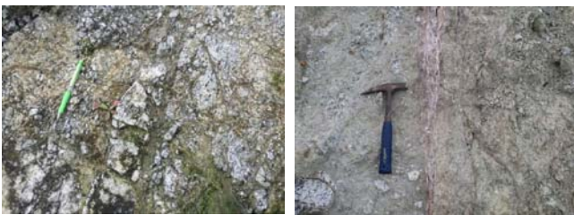
写真-1 角礫化した花崗岩 写真-2 カタクレーサイト
