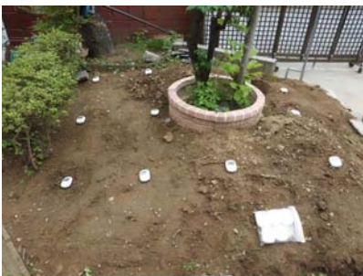
図 1 除染後地表面近傍の放射線量計測の例
