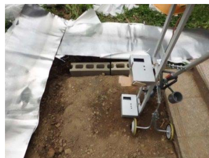
図4 はぎ取り領域の2辺を鉛板(1mm)で遮蔽した状況
