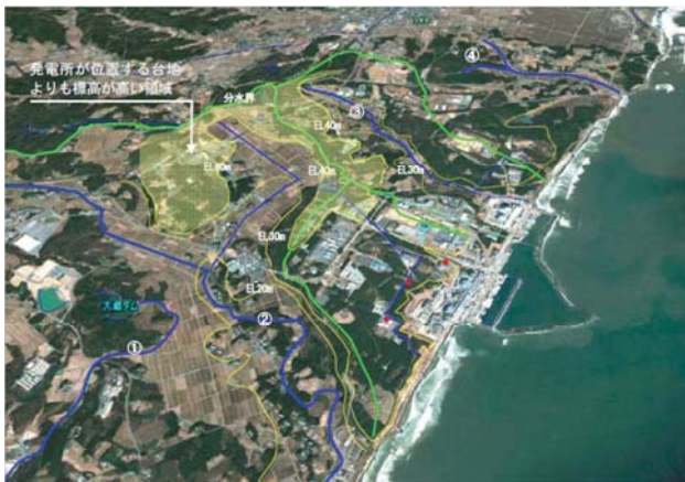
図-1 福島第一原子力発電所付近の地形（青線＝河川，黄緑線＝分水界，文献-6を一部改変）
