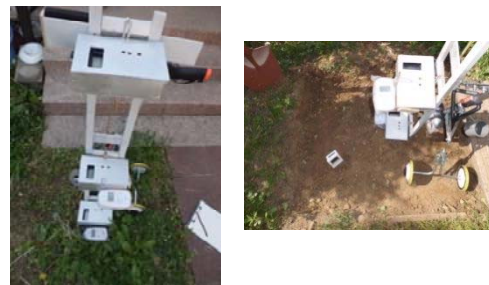
図3 はぎ取り領域と3台の線量計 はぎ取り前(左)と7cmはぎ取り後(右)
