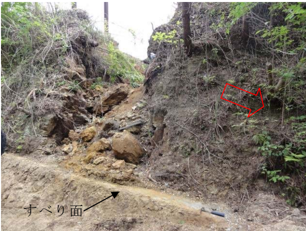
図1 上釜戸地区岩盤地すべり頭部のすべり面と分離ブロック
