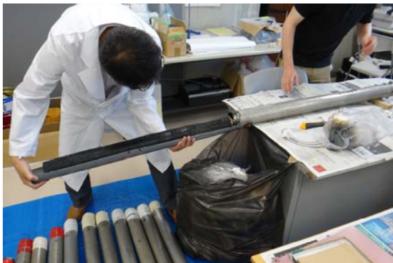
図 4 コア押し出し状況
