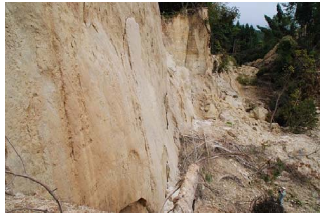
写真-3 荒砥沢北方の横ずれ変位の西方延長部のカルデラ埋積物。既存節理に沿う破断が認められる。
