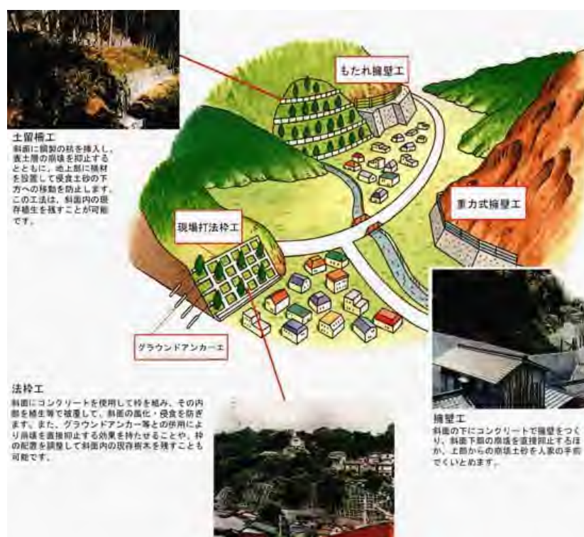
図-3 がけ崩れ対策の模式図 3)
