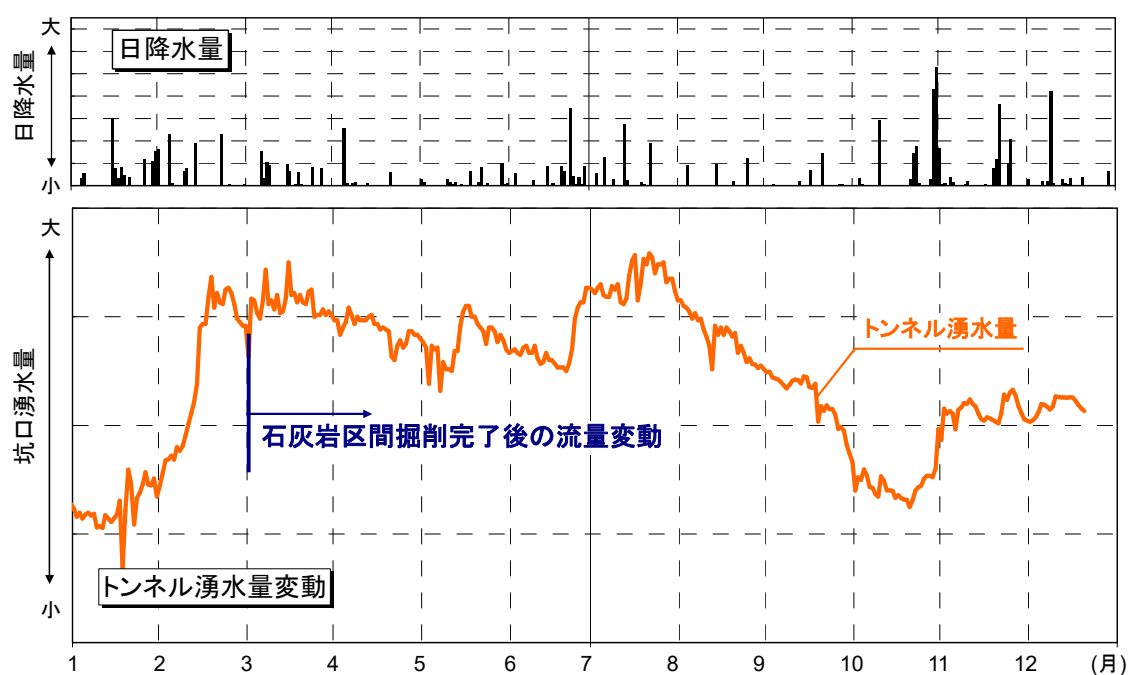
図-5 石灰岩地帯におけるトンネル湧水の観測事例 1)
