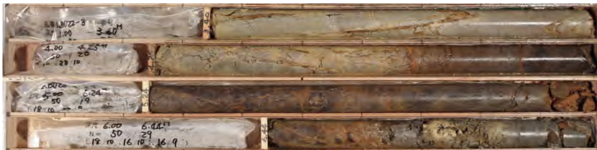
写真-1 風化軟岩の例 1(中生代白亜紀の和泉層群の砂岩・泥岩、香川県)
