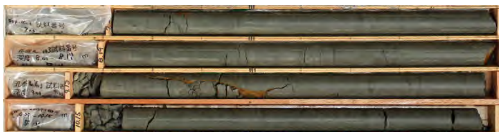
写真-3 堆積軟岩の例(古第三紀の土庄層群のシルト岩・砂岩、香川県)
