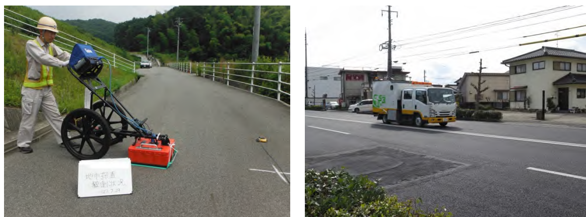
写真-1 探査状況（左：手押し型、右：車載型）
