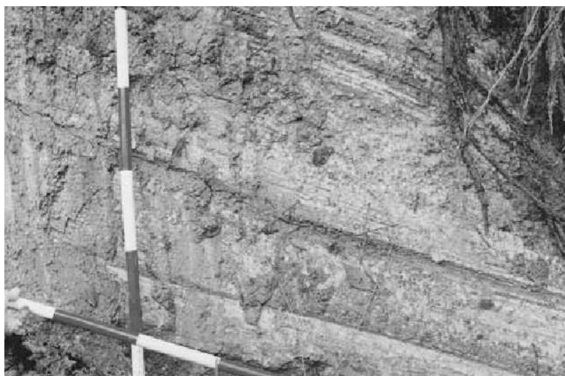
図-2 災害発生時に確認されたすべり面の例 3) (土塊が移動した痕跡である「条線」がすべり面上に認められる。)
