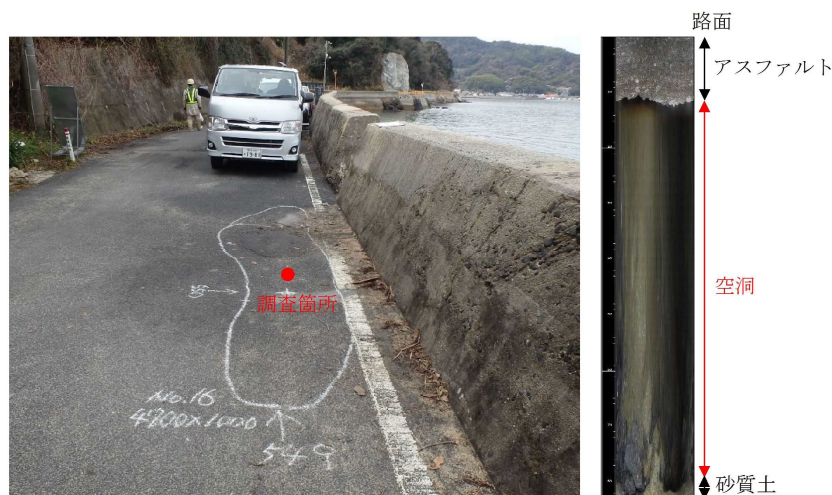
写真-2 地中レーダー探査での異常反射地点とボーリング孔内カメラの映像の例
