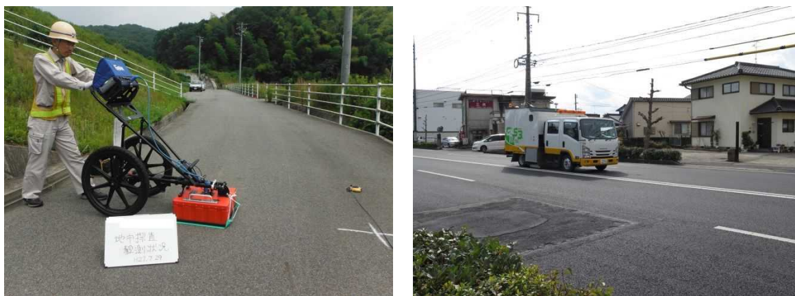
写真-1 探査状況 (左：手押し型、右：車載型)
