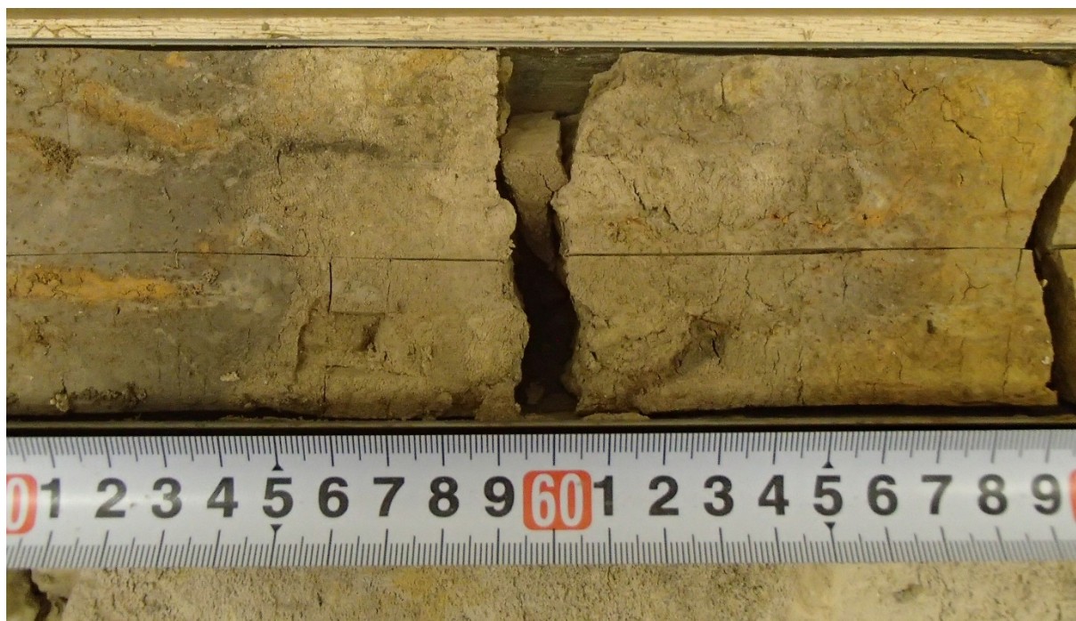
写真-2 愛媛県西予市の K-Ah 火山灰ボーリングコア接写（左がコア上位）
