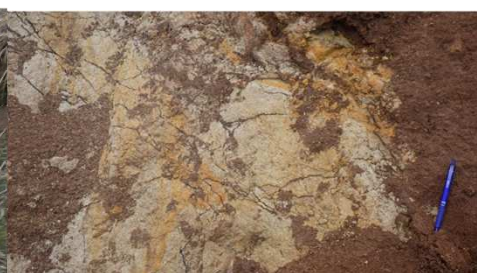
下位の凝灰質シルト岩との境界にすべり面の擦痕あり
