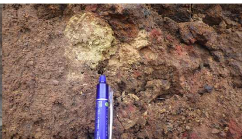
下位の凝灰質シルト岩との境界にすべり面の擦痕あり
