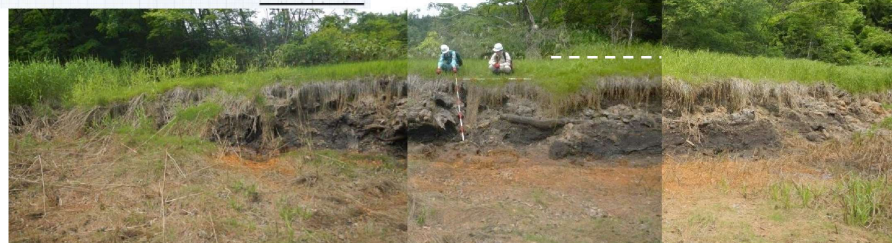
旧水田の上下変位約2mW-E方向の南低下「断層」、背後の高まりとの境界が小崖地形。
