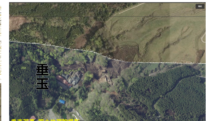
垂玉温泉、地獄温泉の背後斜面の崩壊。崩壊地の上部斜面には、平行する亀裂が発生している。
