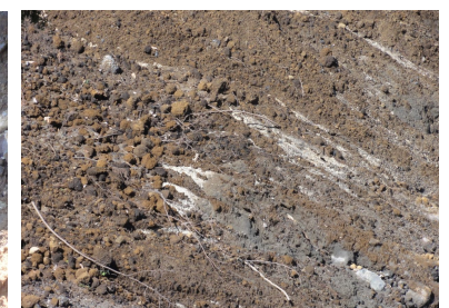
上記の写真の崩壊脚部と推定される面に残る白色の軽石層。
