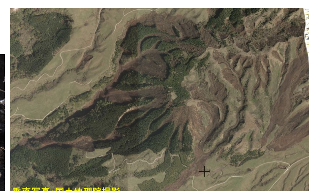
山王谷川上流域の斜面崩壊と、流動化した崩壊土砂。緩斜面で停止している崩壊土砂は溶岩流状の形態でアースフローとされている。(奥野ほか, 2016)
