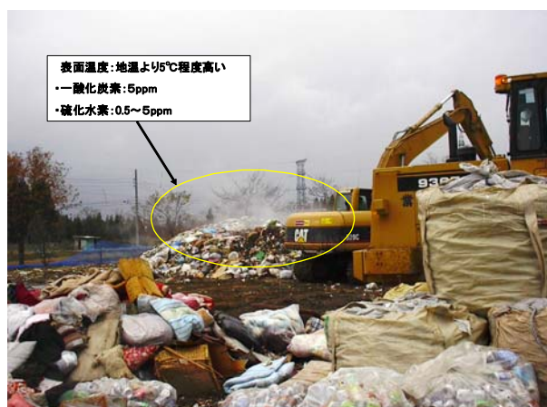
写真-1 可燃ごみ中の有機物の腐敗状況
